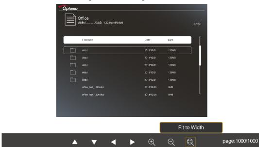
Drücken Sie zur Auswahl einer Steuerfunktion am Bildschirm ◀, ▶, ▲ oder ▼, drücken Sie dann zum Ausführen der Steuerfunktion "←—" am Projektorbedienfeld oder **Enter** an der Fernbedienung.
