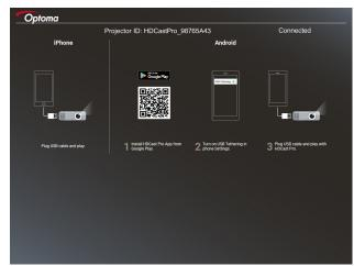
b) Verbinden Sie Projektor und Smart-Gerät über ein USB-Kabel. Der Bildschirm Ihres Smart-Gerätes wird automatisch am Projektor gespiegelt.
